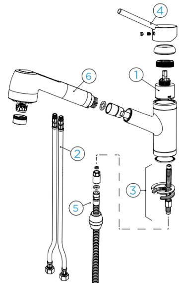
**Hinweis:** Diese Explosionszeichnung bildet die Hochdruck-Armatur mit deren Ersatzteilen ab. Für die Niederdruck-Armatur gelten andere Ersatzteilnummern.
