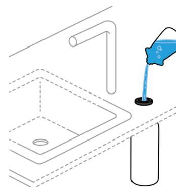
**Hinweis:** Der Ladon kann nur in Verbindung mit einer CRISTADUR® Spüle verbaut werden und bei Einbau in die Arbeitsplatte darf deren Stärke max. 12 mm betragen.
