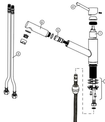
**Hinweis:** Diese Explosionszeichnung bildet die Hochdruck-Armatur mit deren Ersatzteilen ab. Für die Niederdruck-Armatur gelten andere Ersatzteilnummern.
